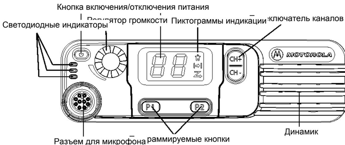
Рисунок 3-4 Панель органов управления мобильной радиостанции системы MOTOTRBO (модель с цифровым дисплеем)
