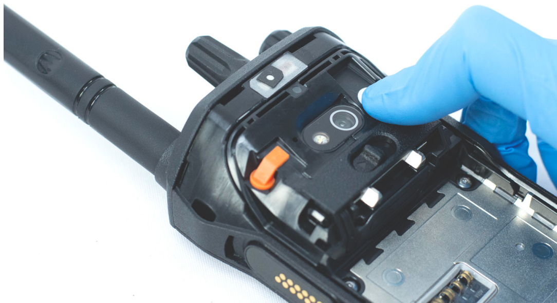
Рис. 28 . Установка герметизирующей мембраны
