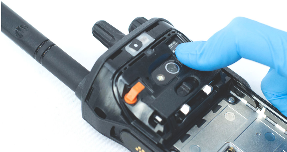
Рис. 30 . Установка наклейки вентиляционного клапана
