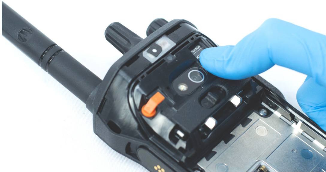
Şekil 30 : Havalandırma Deliği Etiketinin Takılması
