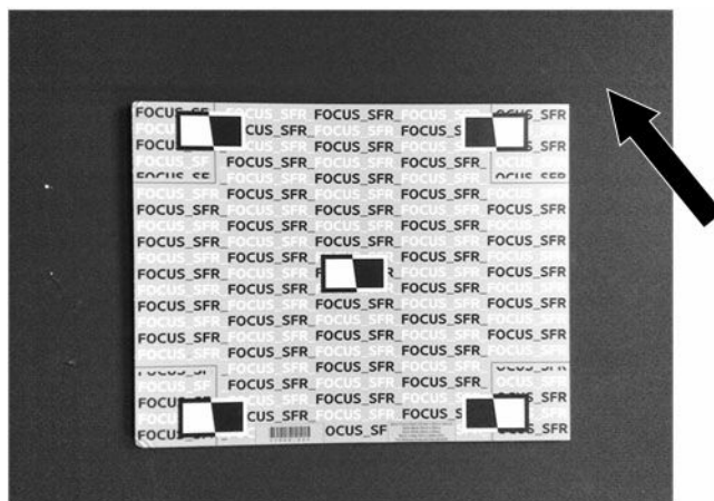
Рис. 14 . Изображение для теста автофокусировки в дальнем поле
