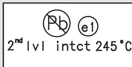
Восстановление или ремонт изделий, предпочтительных для окружающей среды, необходимо выполнять с использованием бессвинцового проволочного припоя или бессвинцовой паяльной пасты в соответствии со следующей таблицей:
