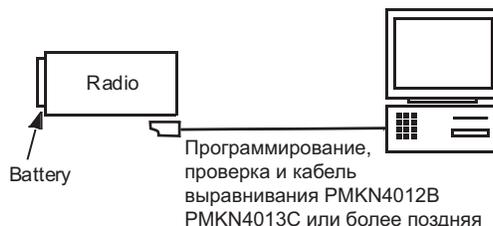
Рис. 4-1. Программная настройка CPS
